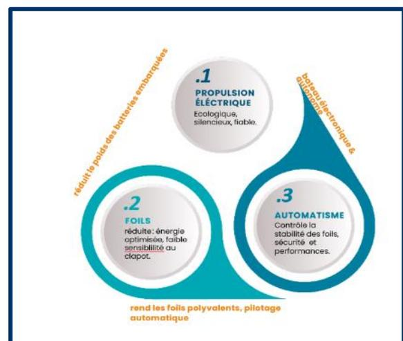
On peut noter différentes caractéristiques et mode opérationnel de l'Overboat :
