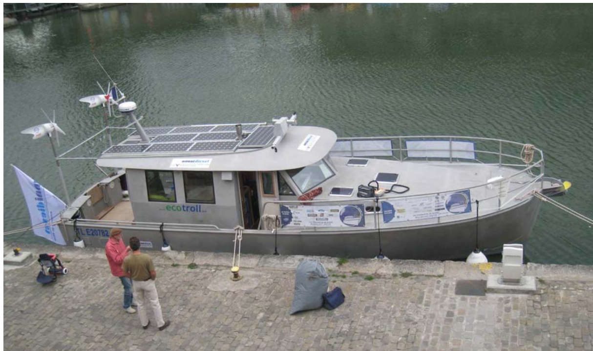
EcoTroll, bateau de voyage construit en Strongall et équipé d'une propulsion hybride
