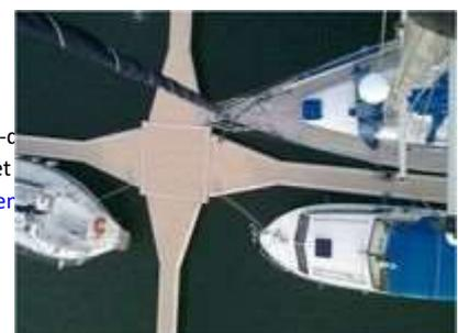
La Fleur de Mouillage est un système flottant de mouillage forain compact et démontable sur pieu articulé. Ce système en forme d'étoile permet d'amarrer plusieurs bateaux à la fois avec un seul point d'ancrage. C'est une réponse au besoin d'optimisation des plans d'eau, pour assurer le mouillage de groupes de 16 bateaux de 8 à 12 mètres.
